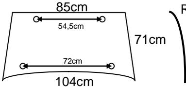
R.2535   | <ul style="list-style-type: none"> <li>Guarnizione sul vetro</li> <li>Apribile con 2 maniglie in plastica a "T"</li> <li>Avvitato</li> </ul>           |
