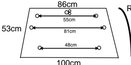
R.2643 | <ul style="list-style-type: none"> <li>Guarnizione sul vetro</li> <li>Apribile con 2 molle a gas e 2 maniglie in plastica</li> <li>Avvitato</li> </ul> |
