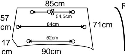
R. 2535  | <ul style="list-style-type: none"> <li>Guarnizione sul vetro</li> <li>Apribile con 2 molle a gas</li> <li>Avvitato</li> </ul>                          |
