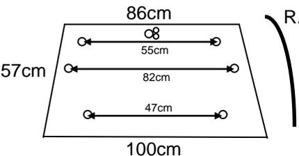
R.1242 | <ul style="list-style-type: none"> <li>Guarnizione sul vetro</li> <li>Apribile con 2 molle a gas Cod: AM675032 e 2 maniglie Cod: MN1</li> <li>Avvitato</li> </ul> |
