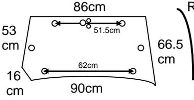
R. 2535  | <ul style="list-style-type: none"> <li>Guarnizione sul vetro</li> <li>Apribile con 2 molle a gas Cod: AM675032 e 2 maniglie Cod: MN1</li> <li>Avvitato</li> </ul> |
