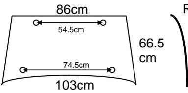
R.2535   | <ul style="list-style-type: none"> <li>Guarnizione sul vetro</li> <li>Apribile con 2 maniglie Cod: MN3</li> <li>Avvitato</li> </ul>                               |
