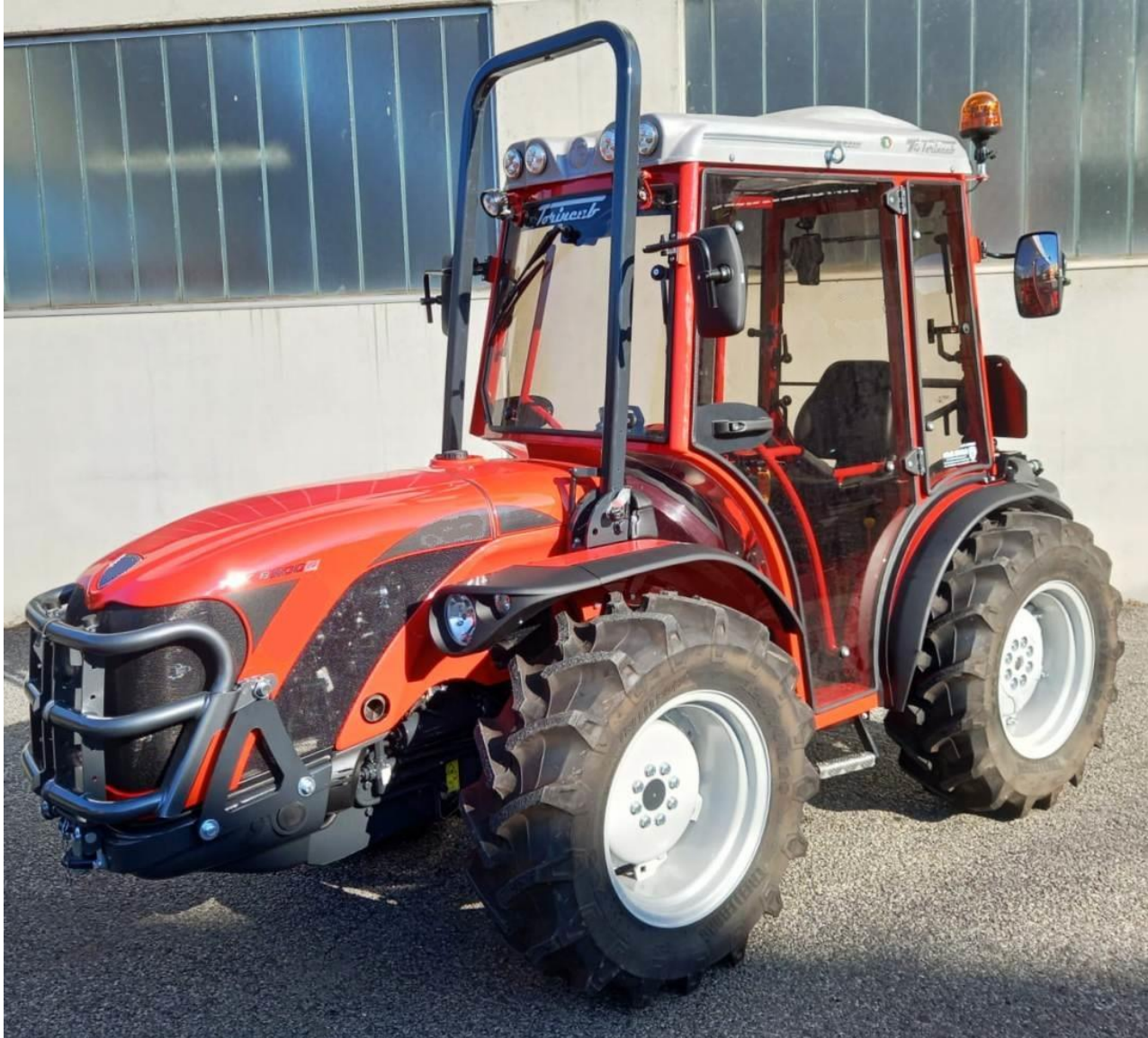
CABINA A. CARRARO TRX 8900 R Gommatura Trattore 300/70 R.20
