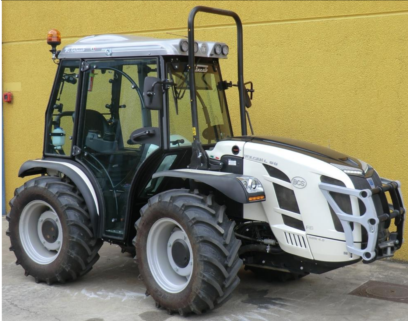
Cabina BCS VOLCAN L80 RS Gommatura Trattore 340/65 R.20
