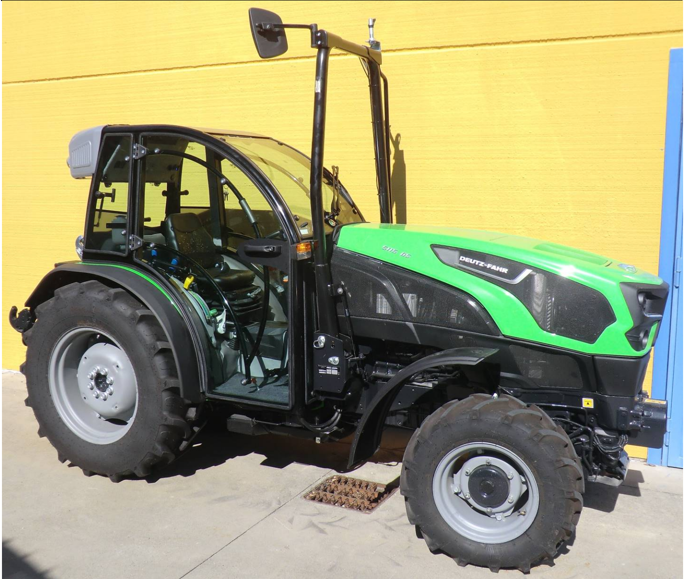
CABINA "COMPACT" DEUTZ-FAHR 5115 DS Gommatura Post. Trattore 380/70 R.24
