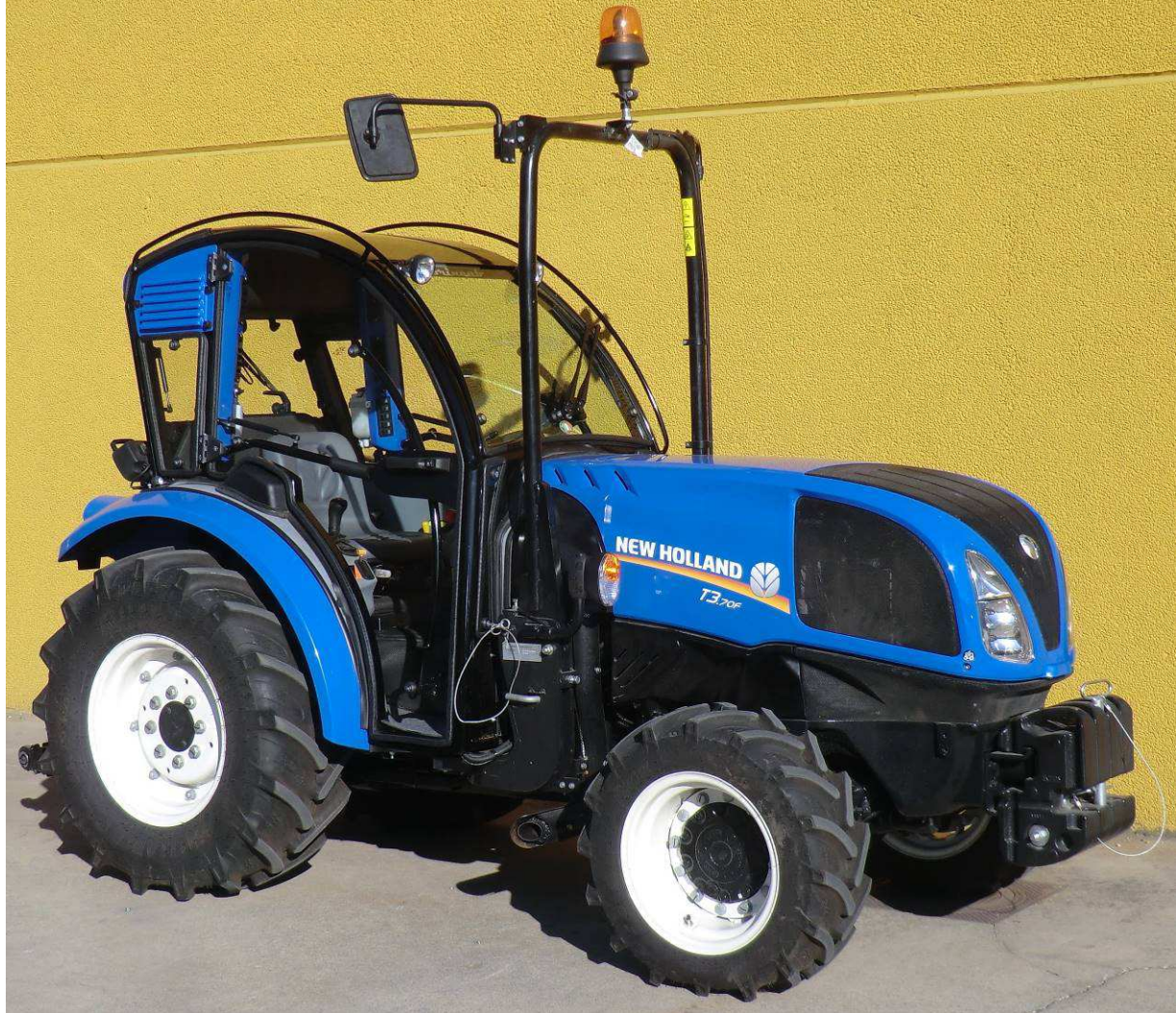
Cabina "COMPACT" NEW HOLLAND T3.70F Gommatura posteriore Trattore 360/70 R.20
