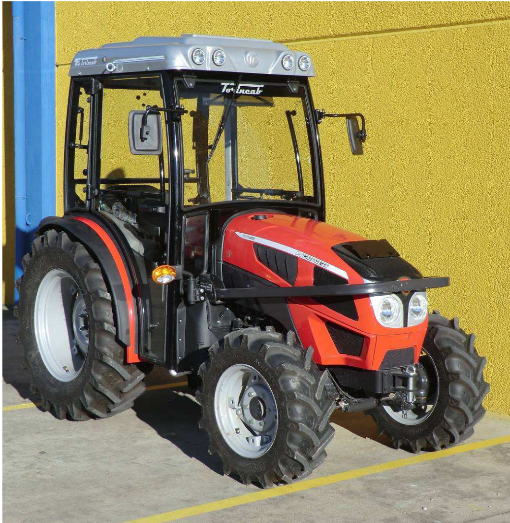
Cabina “STANDARD” VALPADANA 1550 GE Gommatura posteriore trattore 360/70 R.24
