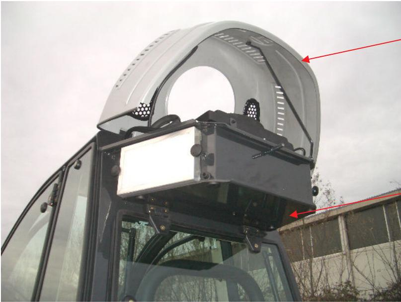
Cupolotto in ABS posteriore apribile tramite cerniere e pomello di chiusura svitabile a mano libera con asta di sostegno in posizione aperta
