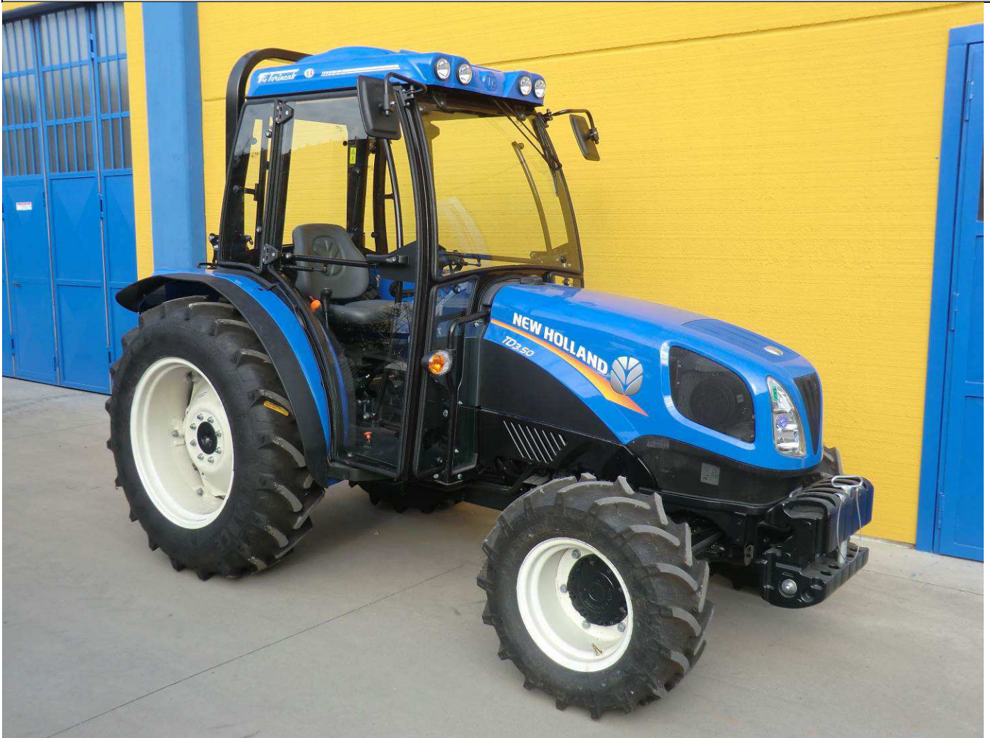
Cabina NEW HOLLAND TD3.50 Gommatura Post. Trattore 340/85 R.28
