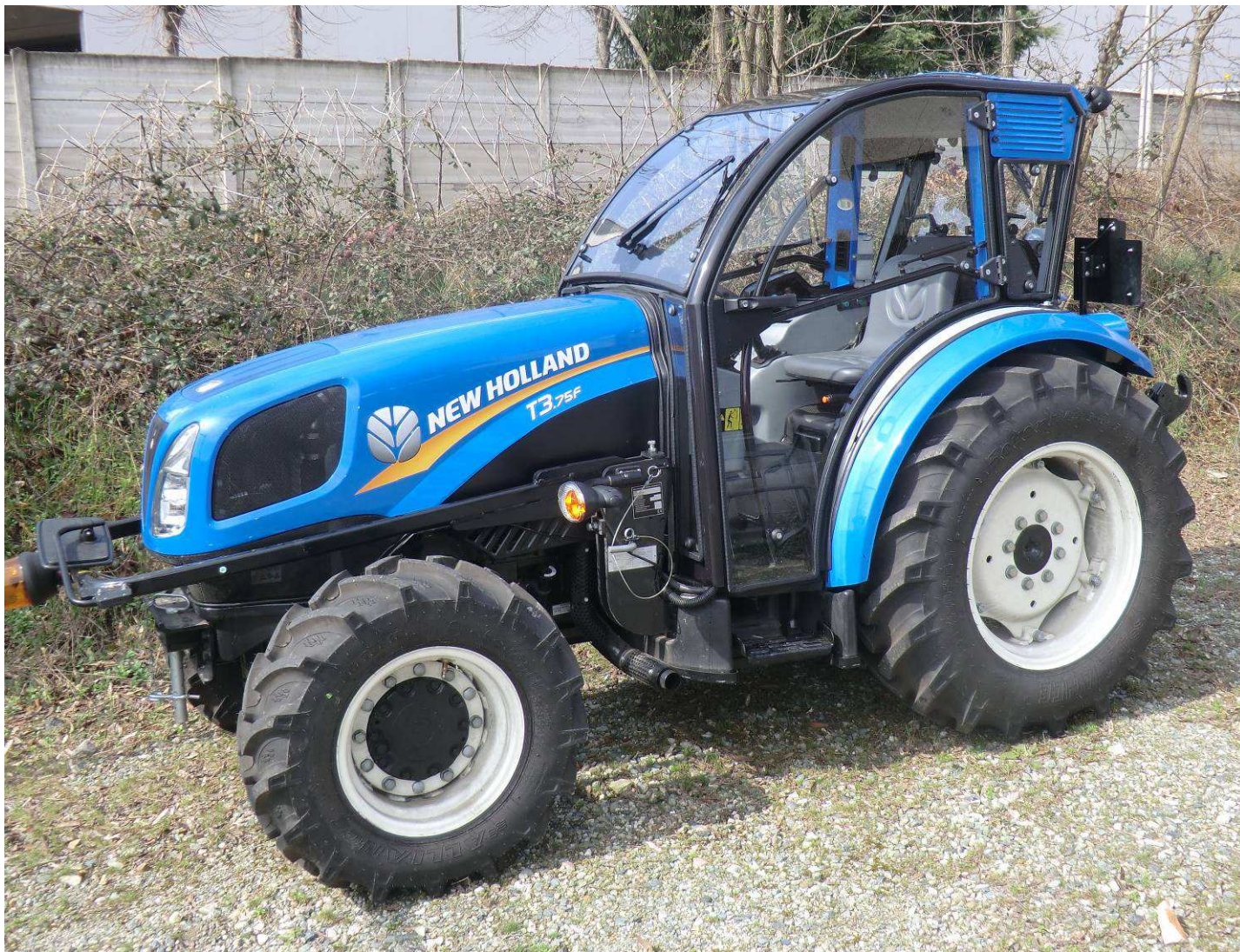
Cabina "COMPACT" NEW HOLLAND T3.75F Gommatura posteriore Trattore 360/70 R.24
