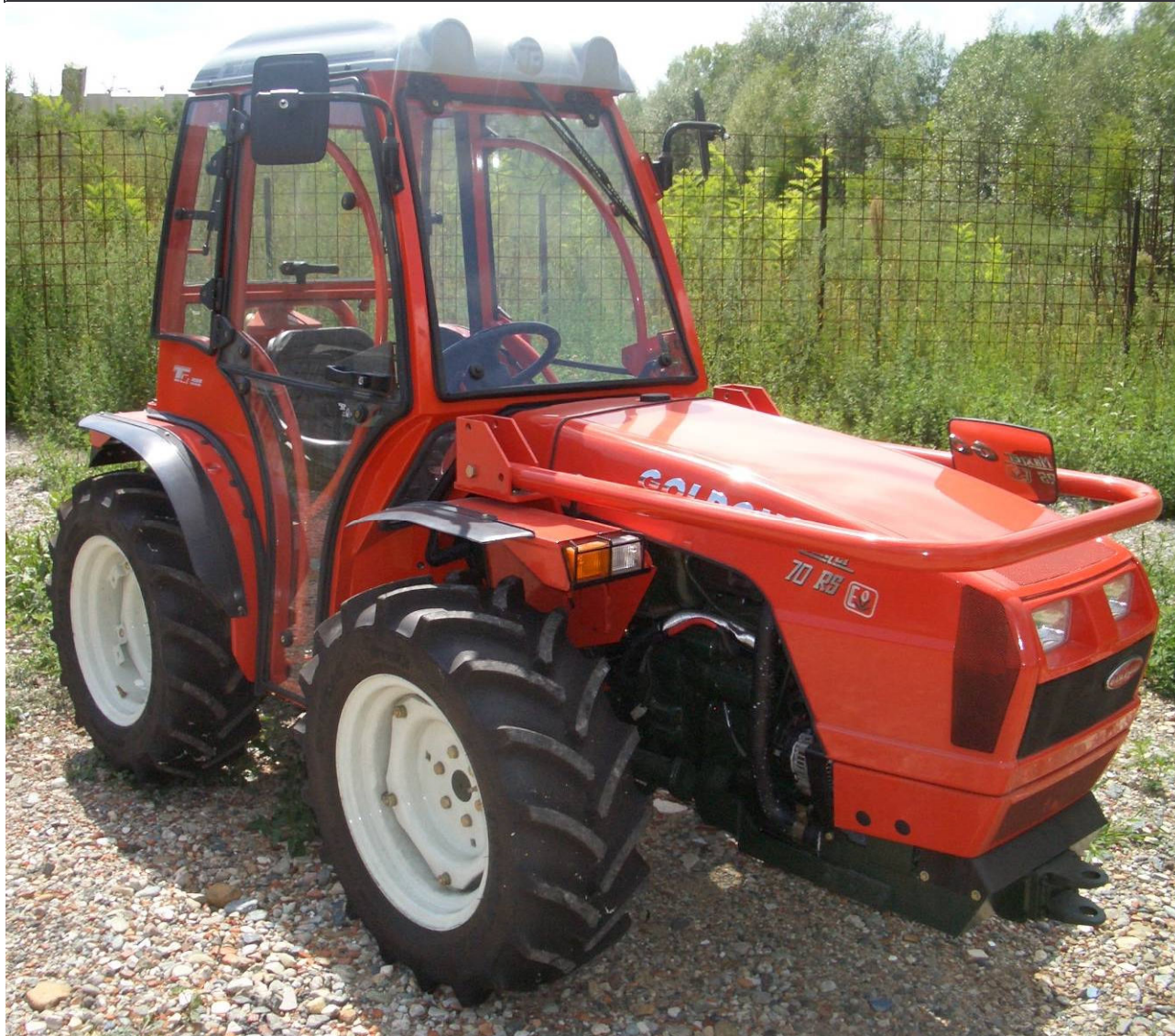
Cabina GOLDONI MAXTER 60-70 RS Monodirezionale Gommatura Trattore 260/70 R.16
