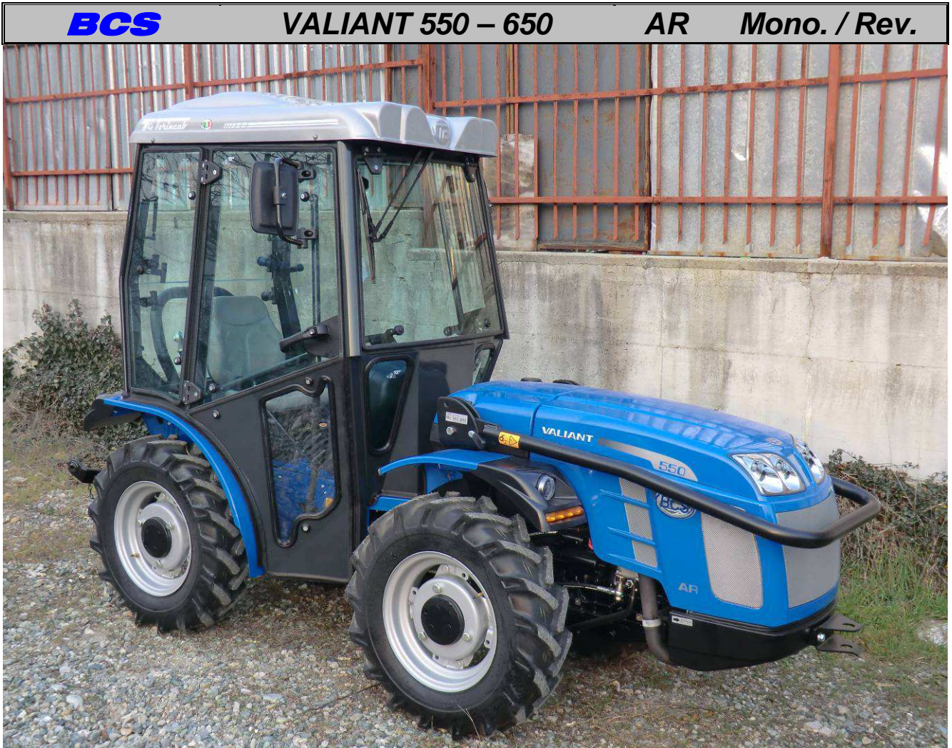
Cabina BCS VALIANT 550 AR Reversibile Gommatura Trattore 280/70 R.18
